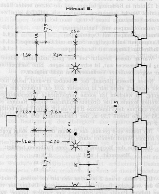
Die verwendeten Glühlampen sind Osramlampen von 600 oder sogenannte Halbwattlampen von 1000 Kerzen.
