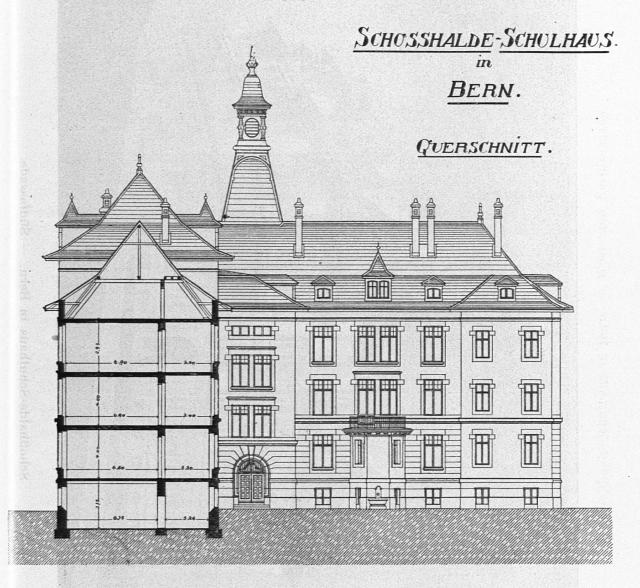
In den Klassenzimmern sind diagonal verlegte buchene Riemenböden, gestemmtes Wandtäfel 1,26 m hoch und Gipsdecken mit Schilfrohrgeflecht. Die Fenster sind dreiflüglig mit Oberlicht, mit aufgesetzten Flügeln mit Doppelverglasung. Zum Schutz gegen die Sonne sind äußere Storen aus Segeltuch mit Ausstellvorrichtung angebracht. Der Ölfarbanstrich der Schreinerarbeiten und der Leimfarbanstrich der Wände sind von hellgrüner Farbe, die Decken sind weiß.
