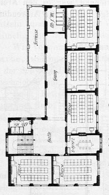
Grundriss vom I. und II. Stockwerk. Masstab 1:600.
