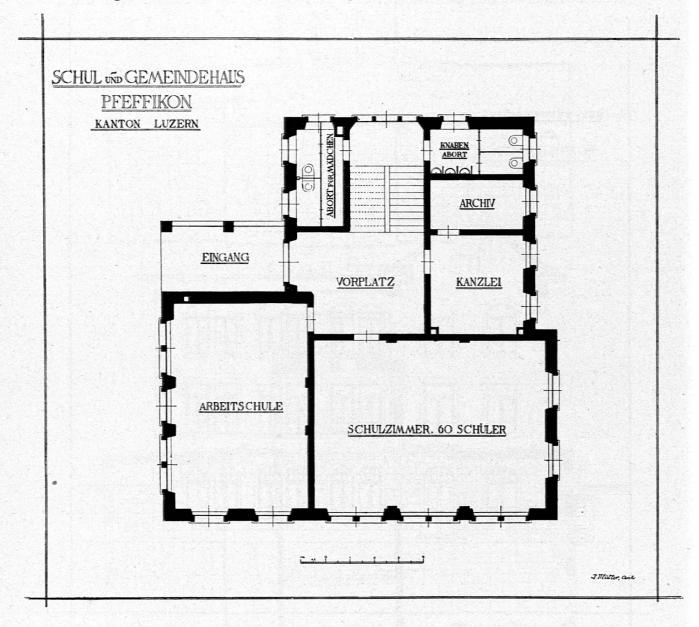
und Breite 6,9 m im Lichten, somit Bodenfläche 65,2 m², oder bei 60 Schülern auf je ein Schüler 1,08 m², Luftkubus 208,04 m³, oder pro Schüler 3,5 m³. Das kleinere Zimmer hat eine Länge von 8,4 m und eine Breite von 5,45 m im Lichten. Das ergiebt eine Bodenfläche von 45,78 m² und einen Luftkubus von 146,5 m³. Da hier die maximale Schülerzahl 30 beträgt, so trifft es auf den Schüler 1,52 m² Bodenfläche und 4,88 m³ Luftraum. Ins Erdgeschoss führt
