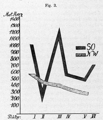
Die erste Versuchsreihe (Lavaterschulhaus) soll uns zeigen, wie gross die Schwankungen der Platzhelligkeit sein können, da wo die Möglichkeit direkter Sonnenbestrahlung der Arbeitsplätze gegeben ist, wie gleichmässig dagegen die Beleuchtungsintensität der Plätze vom Fenster zur Innenwand abnimmt, wenn nur diffuses Tageslicht ins Zimmer tritt.
