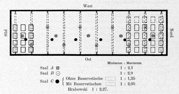
vorgenommen wurden, sind nicht eingezeichnet. In den Sälen der untern 2 Stockwerke bestanden die einzelnen Reihen aus 4, in demjenigen des Dachstocks ebenfalls, mit Ausnahme der von rechts gerechnet ersten 5 Reihen, in welchen im Seitengang, der ursprünglich frei bleiben sollte, je ein Tisch eingesetzt war. Diese letzteren Tische sind auf der Planskizze punktiert.
