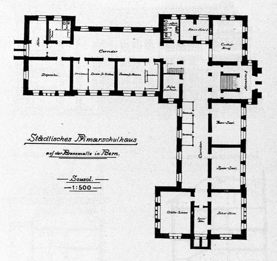
Der Flächeninhalt der Klassenzimmer beträgt 60 bis 62 m<sup>2</sup>; diese Abmessungen ergeben einen kubischen Inhalt pro Klasse von 216 bis 223 m<sup>3</sup> oder für Klassen, die für 44 Schüler berechnet sind, ein Luftquantum pro Schüler von 4,90 bis 5 m<sup>3</sup>.
