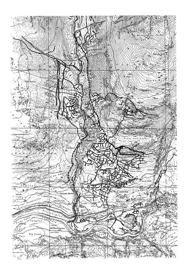
Abb. 22: Historisches Bewässerungssystem im Untersuchungsraum Guarda. Südlicher Ausschnitt.
