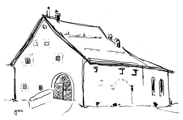
Herrschaftliches Engadinerhaus in Chamues-ch. In der Mitte des 16. Jhs. erbaut, Mitte des 18. Jhs. erweitert und mit steilem genageltem Schindeldach versehen. Ursprüngliches Haustor an der Traufseite noch erkennbar.
