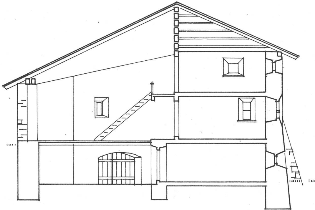
Abb. 36 Schnitt durch ein einfaches Engadinerhaus in Puntraschna (Nr. 164). Vom palintschia , der hier zugleich Hausflur ist, führt eine Treppe zur Schlafkammer über der Stube. (Maßstab 1:150).
