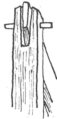
Abb. 46c Scherzapfen forsch zur Verbindung eines Rafenpaars.
