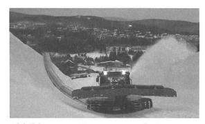
Abbildung 15: Pipe-Monster beim Präparieren einer Halfpipe-Piste. (Bild: Zaugg AG)
