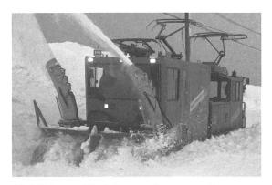
Abbildung 14: Schneeräumen mit Schneefrässchleuder, Wengernalpbahn. (Bild: Zaugg AG)
