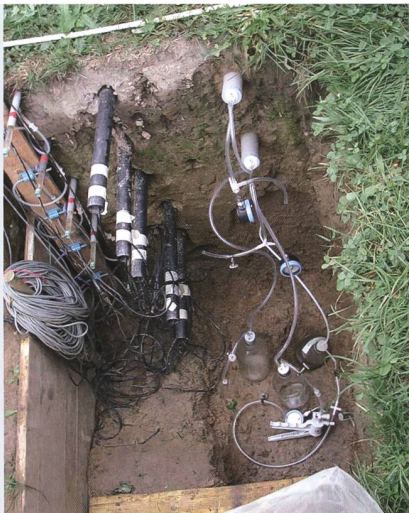
Tandem-Beregnung zur Ermittlung der hangparallelen Sickerung,
