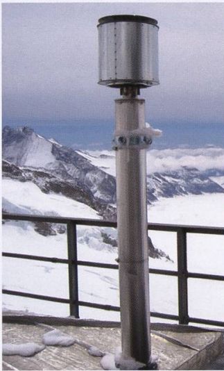
Abbildung 2: Das Einlass-System für die Aerosolmessungen. Es ist so konzipiert, dass auch die in Wolkenröpfchen enthaltenen Aerosolpartikel mit erfasst werden.
