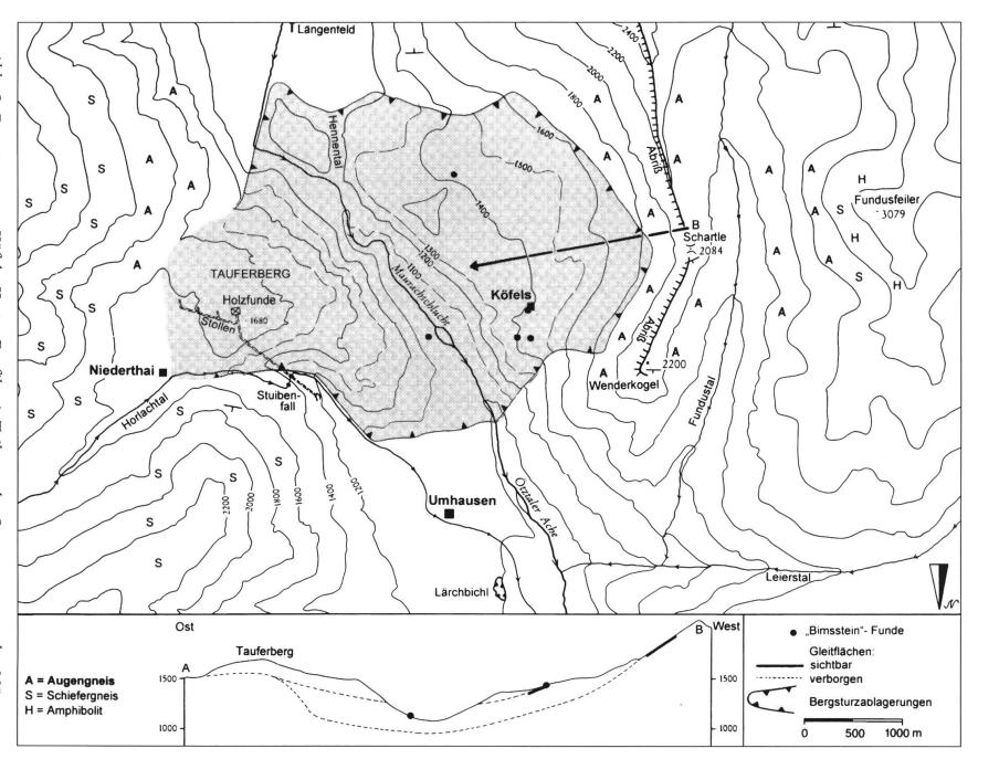
dungsstufe des Horlachtals. Norden ist rechts (Ergänzt nach HEUBERGER et al., 1984: 349, Fig. 3). Abb. 3: Bergsturz von Köfels. Karte, Profil mit Teilung der Sturzmasse an der Mün-
