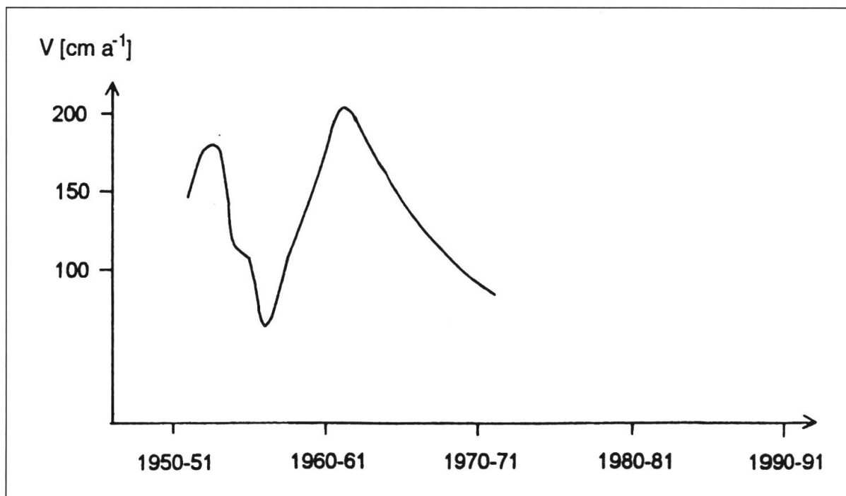
Abb. 4: Änderungen der Horizontalbewegung des Blockgletschers Hochebenkar. Daten aus VIETORIES (1972), vgl. BARSCH (1996).
