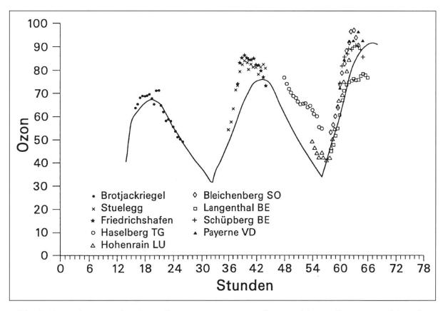
Abb. 9. Berechnung der Ozonkonzentration mit dem HPTM entlang einer Trajektorie Thüringerwald–Bern vom 24.–26.7.1990. Die Symbole markieren Messungen von Bodenstationen.
