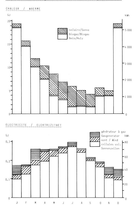
Figur 2: Die Energieerzeugung unterliegt starken jahreszeitlichen Schwankungen (dargestellt für Wärme und Elektrizität in verschiedenen Massstäben).
