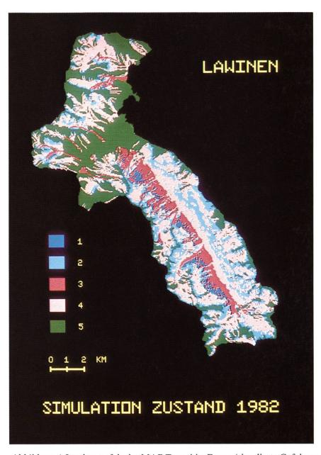
Abbildung 4: Lawinengefahr im MAB-Testgebiet Davos (simulierte Gefahren-Hinweiskarte, Zustand 1982)
