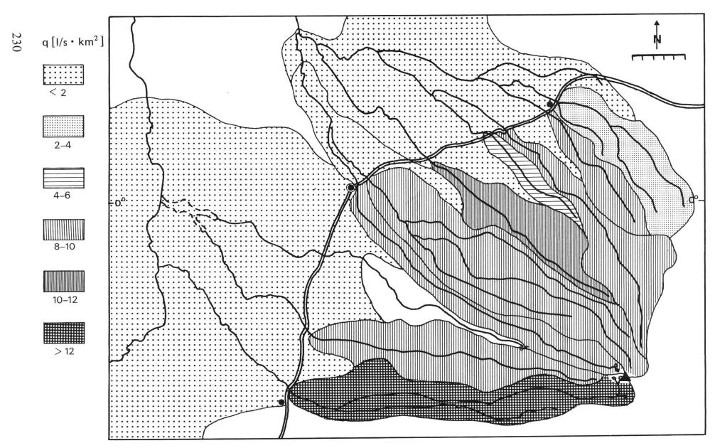
Abbildung 10: Abflussspenden des mittleren Abflusses der Periode 1960–1980. Die Spenden sind als Mittelwert über das gesamte jeweilige Einzugsgebiet angegeben. Die Klasse 6–8 l/s.km² fehlt. Flussbezeichnungen s. Abb. 3.
