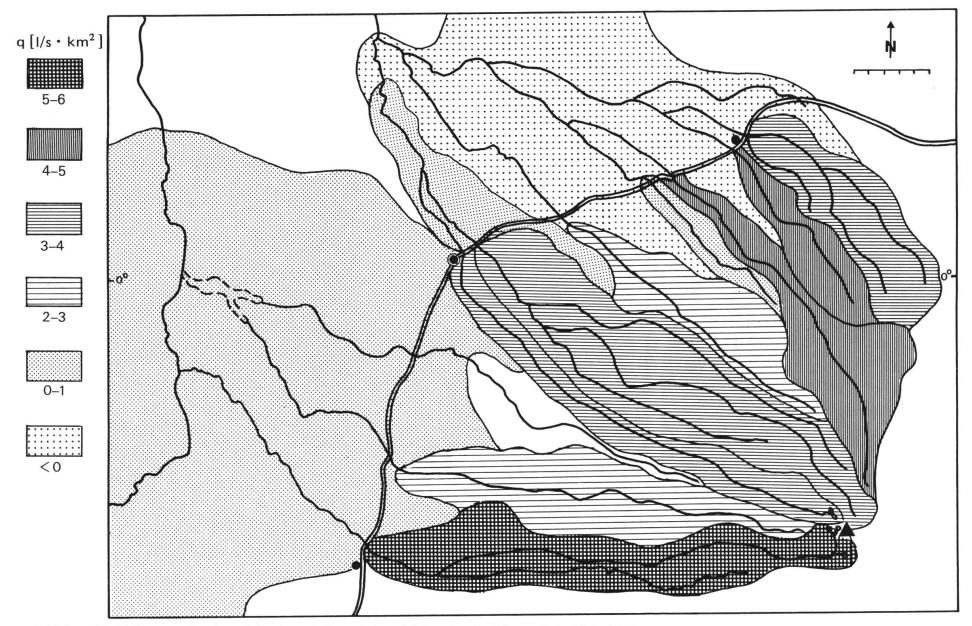
Abbildung 11: Abflussspenden der minimalen mittleren Jahresabflüsse aus der Messperiode 1960–1980. Die Klasse < 0 l/s.km² bedeutet, dass in diesem Teileinzugsgebiet mehr Wasser durch Verdunstung, Versickerung und Entnahmen verbraucht wird als in diesem Gebiet in Trockenzeiten durch Niederschlag eingetragen wird. Die Klasse 1–2 l/s.km² ist nicht vertreten. Flussbezeichnungen s. Abb. 3.
