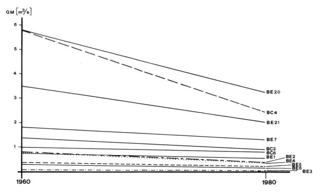
Abbildung 16: Regressionsgeraden der jährlichen Mittelwasserabflüsse (QM<sub>y</sub>) in der Periode 1960–1980. Gesamthaft ist eine fallende Tendenz der Abflussmengen in der Messperiode vorhanden.
