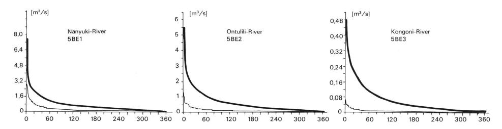
Abbildung 13: Dauerkurven des Abflusses. —— Periode 1960–1980. —— Trockenjahr 1980. Aus der Dauerkurve kann herausgelesen werden an wievielen Tagen im Jahr ein bestimmter Abflusswert erreicht oder überschritten wird.
