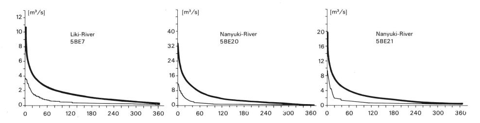
Abbildung 14: Dauerkurven des Abflusses ——— Periode 1960–1980, ——— Trockenjahr 1980.
