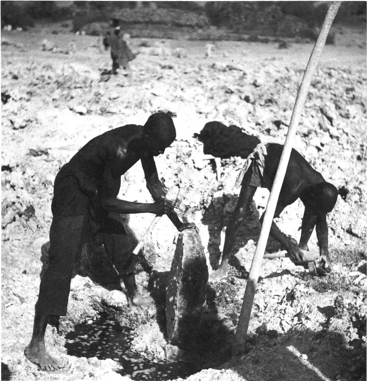
Abbildung 7: Stets waren es nur die «Adad», Männer der untersten Kaste der Kanembu, welche in einer Art Leibeigenschaft mit einfachsten Arbeitsgeräten das Natron zu Platten behauten.
