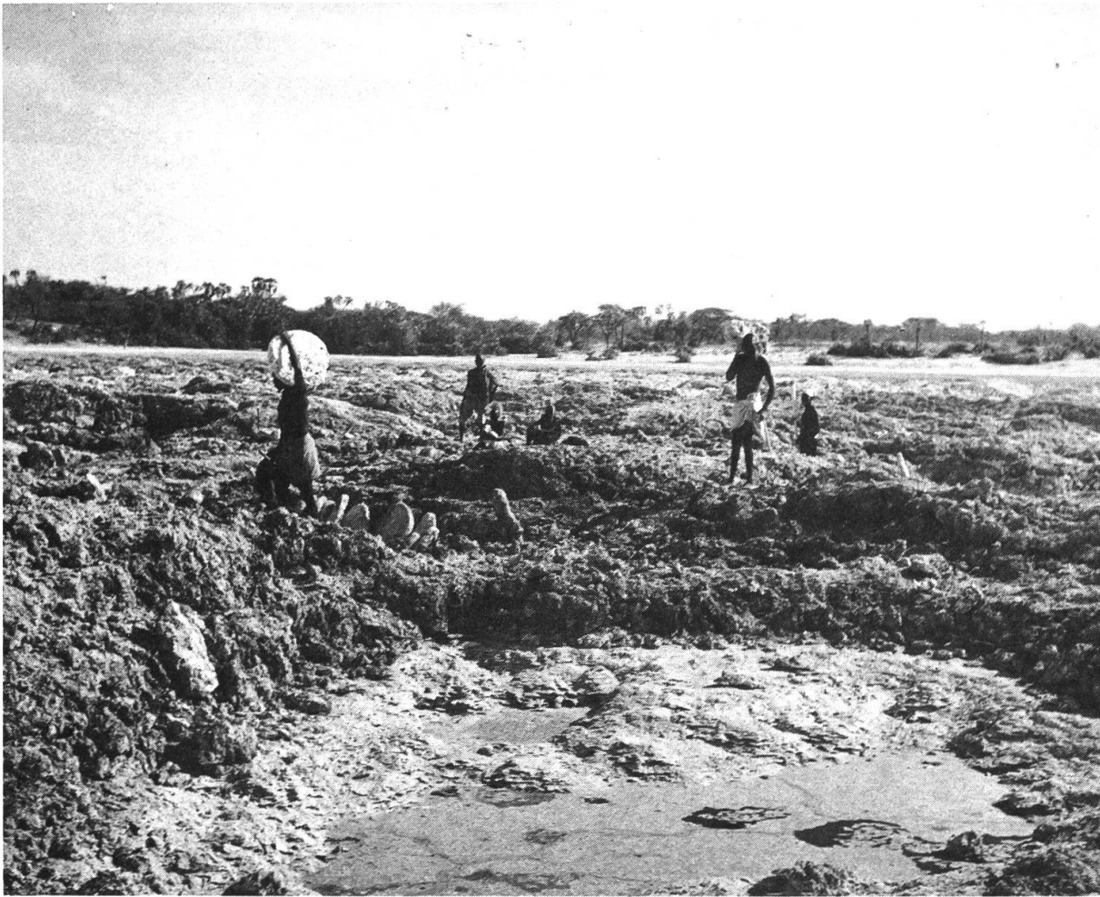
Abbildung 5: Eine «Daya» – ein Natronsee im Norden des Tschadsees – kurz vor dem vollständigen Austrocknen. Über der dunkelbraunen Sole bildet sich allmählich eine dicke Kruste, die herausgebrochen wird.
