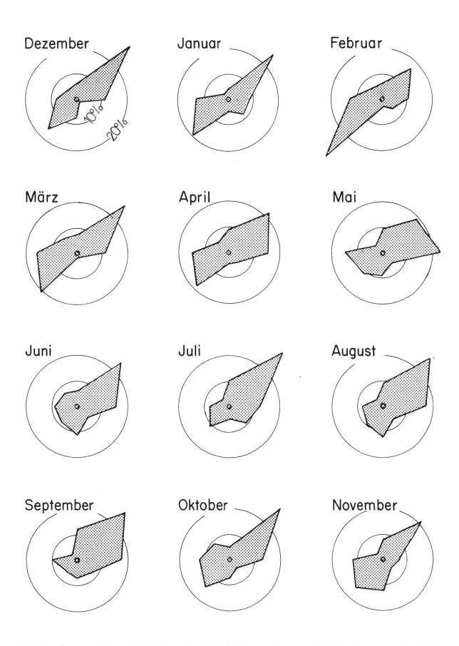
Abbildung 4 Die relativen Häufigkeiten der Windrichtungen als monatliche Windrosen aus den 07.30-Uhr-Beobachtungen der Jahre 1966–1970
