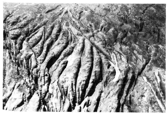
Abb. 4: Bruchtektonik in den kambroordovicischen Sandsteinen östlich Zouar. Die beiden Hauptrichtungen mit zahlreichen Interferenzerscheinungen, Blattverschiebungen usw. sind deutlich erkennbar. (Vergl. Fig. 1 und Satellitenbild).
