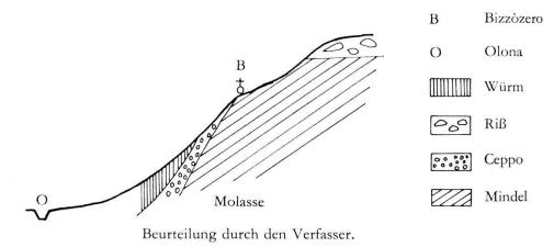
Figur 1. Schematische Darstellung der Quartärablagerungen bei Bizzòzero.
