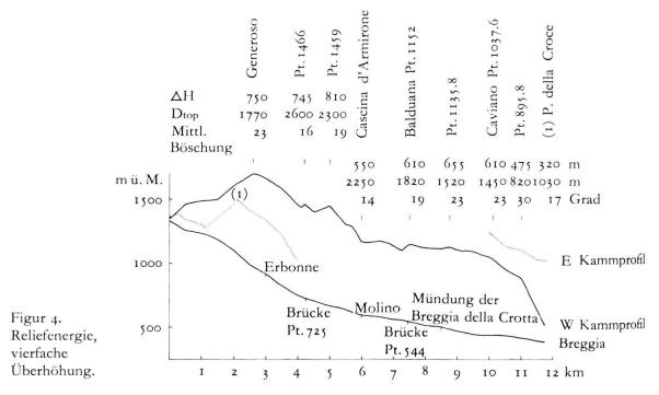
Figur 4 zeigt, daß die Reliefenergie unseres Untersuchungsgebietes durchwegs bedeutend ist. Im Gebiete der größten  $\triangle H$ -Unterschiede, das heißt zwischen A. d'Orimento und Cascina d'Armirone, besitzt die Breggia auch ihr größtes Gefälle. Mit dem Übergang zum flachen, sich nach Caviano hinziehenden Dosso macht sich eine Gefällsverminderung in der Talsohle bemerkbar; die Werte der Reliefenergie verzeichnen jedoch nur geringe Abnahme gegenüber dem Generosogebiet.
