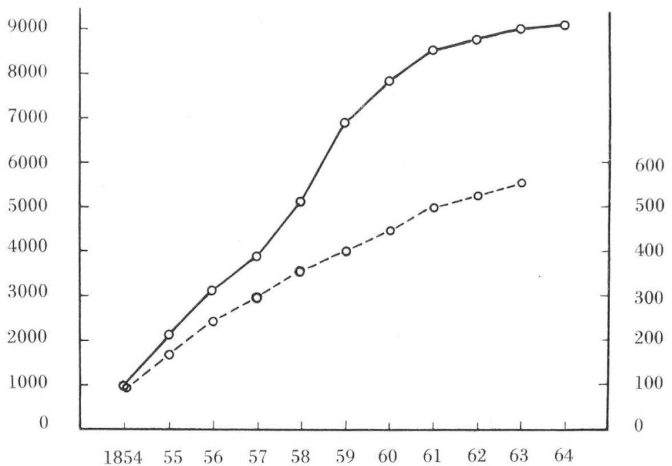
Bis und mit 1863 wurden auf 552 Stationen 9037 Winkel gemessen. Die starke Zunahme der Zahl der Winkel in den Jahren 1858 und 59 bei gleichmässigem Ansteigen der Zahl der Stationen ist durch eine sorgfältigere Auswahl der Stationen und wohl auch durch das leichte Abnehmen der Zahl der Signalstörungen zu erklären. Die später geringe Vermehrung der Winkelzahl deutet u. a. auf die grossen Schwierigkeiten im Gebirge hin.
