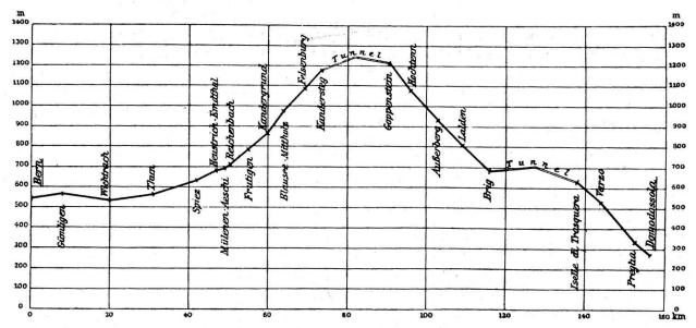
Profil der Strecke Bern—Lötschberg—Simplon. Höhen im Verhältnis zur Entfernung 50mal größer. Da die Tunnelmündungen Kandersteg und Goppenstein rund 1200 m ü. M. liegen, hat der Lötschbergtunnel, im Gegensatz zu dem als Basistunnel anzusprechenden Simplontunnel, den Charakter eines (wenn auch nicht reinen) Scheiteltunnels.
