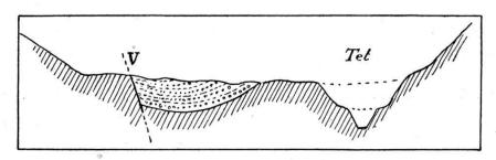
Abbildung 9. Profil durch das Tal der Tet bei Villefranche mit Verwerfung (V) am Rande der Pliocänbildungen.
