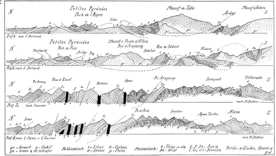
Abbildung 4. Geologische Profile durch die Pyrenäen.
