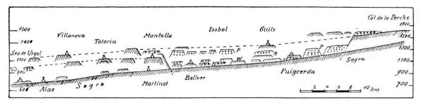
Abbildung 58. Längsprofil des Segretales zwischen dem Col de la Perche und Seo de Urgel, mit tertiären und diluvialen Talterrassen (stark überhöht).
