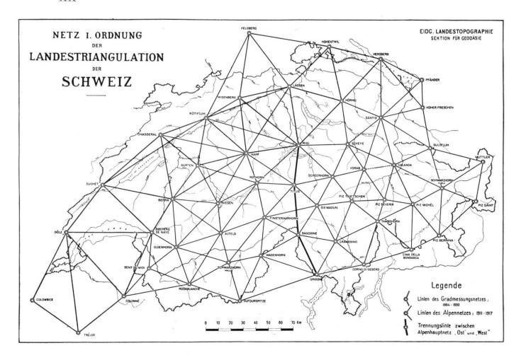
23. Trigonometrisches Netz I. Ordnung, fast 1:3000000 zu S. 141.
