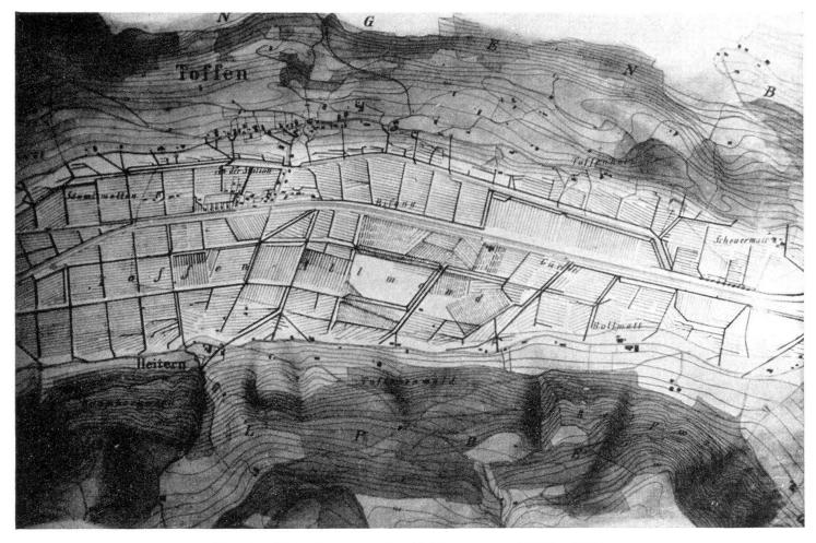
Fig. 14. Entwässerung des Toffenmooses (1919-1923)
