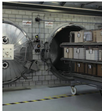
Papersave swiss Anlage, Wimmis. Eine sogenannte «Charge» wird in die Kammer gefahren.
