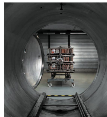
Papersave swiss Anlage, Wimmis. Eine sogenannte «Charge» wartet auf die Entsäuerung.
