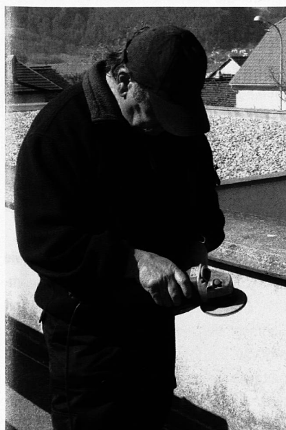
Heute werden die Scheren mit modernen Hilfsmitteln, wie etwa einer elektrischen Schleifscheibe geschliffen.
