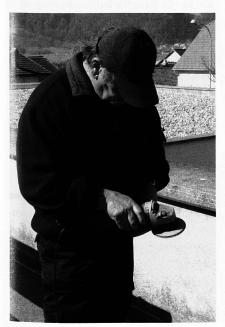
Heute werden die Scheren mit modernen Hilfsmitteln, wie etwa einer elektrischen Schleifscheibe geschliffen.
