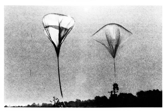
Stratosphärenballon mit Hilfsballon und Instrumentengondel
