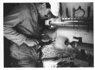
So sauber und exakt überdrehen, dass nicht geschliffen werden muss. Die Oberfläche wird wie gehobelt. Mit Schleifmitteln würde sie nur zerkratzt.
