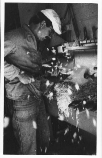
Die grobe Form nach Augenmass herausschroppen, so dass die Späne fliegen.
