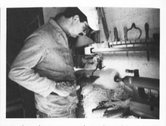
Nochmals etwas nachstechen, bis sich der Taster über die Dicke schieben lässt. Der Durchmesser an dieser Stelle ist jetzt etwa 4 mm grösser als am Endprodukt. Es hat noch genug Holz, um einen Schlichtspan abzunehmen.
