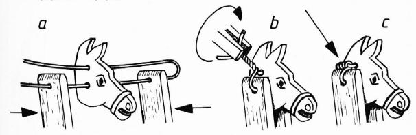
Den Draht umbiegen, einfädeln und beide Kufen zusammenschieben. Beide Drahtenden mit einer Flachzange anziehen und eindrillen. Die Bindung bis auf einen Stummel kürzen und andrücken.
