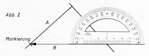
Abb. 3. Konstruktionsschema für Sonnenuhr- Zifferblatteinteilung
