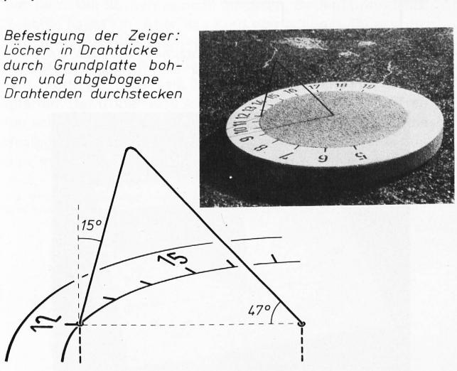
Abb. 5 Stundenzeiger aus 3 bis 4 mm dickem Sperrholz, starkem Karton oder Aluminiumblech
