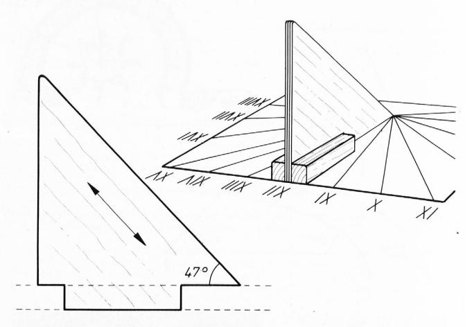
Zeigerdreieck mit Verstärkungsklötzchen auf das Zifferblatt oder in ausgesägten Schlitz der Grundplatte leimen
