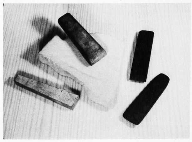
Um eine regelmässige Rundung des Meissels zu erhalten, muss man ihn mit wiegender Bewegung schleifen. Der Meissel soll gegen das Nackenende hin leicht konisch verschmälert sein. Alle Flächen werden überschliffen und die Kanten gleichzeitig gerundet. Ist der Meissel fertig, fetten wir ihn etwas ein, damit er schöner zur Geltung kommt.
