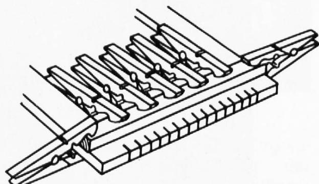
Webrahmen verschleifen. Für die Längsseiten eignen sich Schleifbretter von etwa 60 cm Länge am besten. (Schleifbretter lassen sich leicht herstellen, indem man Schleifpapier auf gerade, etwa 3 cm starke Spanplattenreststücke aufleimt). Garnaufspannschlitz mit Schleifpapier 180 besonders sorgfältig verschleifen.
