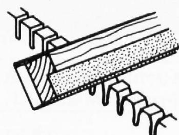
Abschliessend kann das Rähmchen durch zweimaliges Anstreichen mit verdünntem Seidenglanzlack imprägniert werden. Nach dem Trocknen des ersten Anstriches sollte mit feinstem Schleifpapier nachgeschliffen werden.
