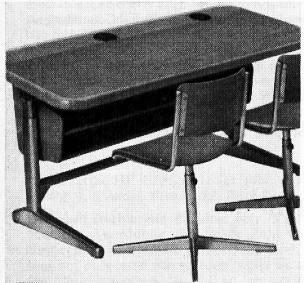
Tischplatte 120 x 53 cm, in Pressholz, Messer- und Schälfurnier oder Kunstharz-belag, Höhenverstellung mit Embru-Getriebe oder Feder-mechanismus und Klemmbolzen, mit oder ohne schrägstell-barer Tischplatte, Tischhöhe speziell tiefstellbar.
