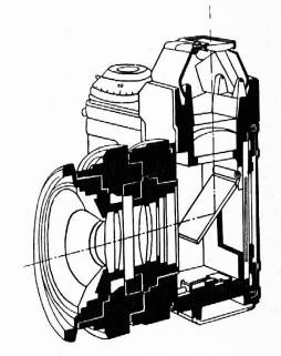
Schnitt durch einäugige Spiegelreflexkamera
