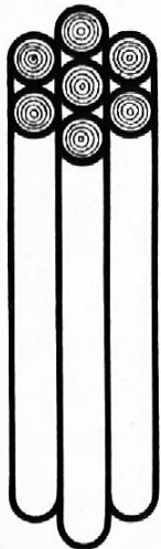
Schematische Darstellung des Aufbaues des Holzes in Längsrichtung.
