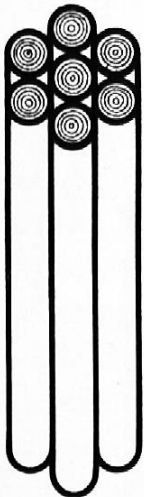
Schematische Darstellung des Aufbaues des Holzes in Längsrichtung.
