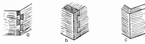
a) Sichtbare Zinkung b) Verdeckte Zinkung c) Doppelt verdeckte Zinkung
