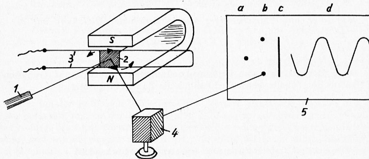
Von einer speziellen Lampe (1) wird ein Lichtstrahl gegen einen Spiegel (2) gelenkt. Dieser Spiegel ist an einem Draht (3), welcher schleifenförmig im Magnetfeld des Hufeisenmagneten ausgespannt ist, beidseitig befestigt. Dort wird der Lichtstrahl auf einen zweiten, drehbaren Spiegel (4) reflektiert und vom letzteren gegen die Wandtafel (5) geworfen.
