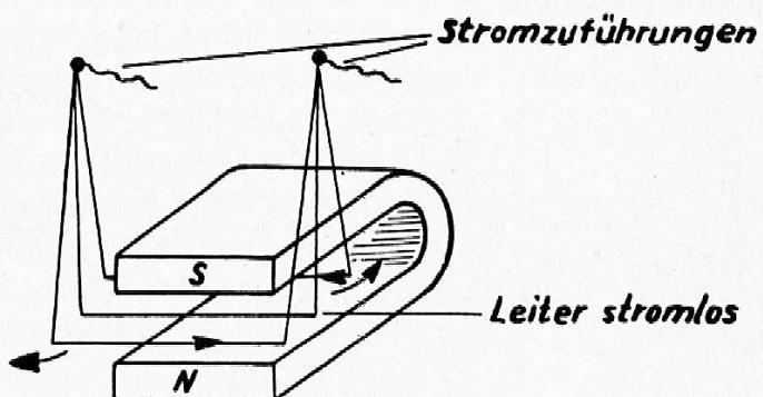
**Auswertung:** Ein gleichstromführender Leiter wird aus dem Magnetfeld herausgestoßen, und zwar, je nach Stromrichtung, auf die eine oder andere Seite.
