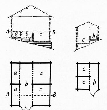
Abb. 12. Aufriß und Grundriß zweier «kleiner Feldbargen» (siehe Abb. 13) im Feld, Gemeinde Calfreisen (Schanfigg). a, c Kornkasten, b Tenne. Zeichnung T. Nigg.
