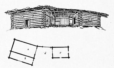
Abb. 17. Barge (a) mit Stall (b), Hütte (c) und «Ladbarge» (d) in Zaläz, Gemeinde St. Peter (Schanfigg). Zeichnung T. Nigg.
