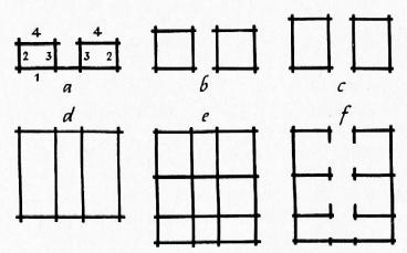
Abb. 11b. «Große Feldbarge.» Schematische Darstellung der «Ringe» eines Kornspeichers mit «Vorspann», wie er für Castiel und Calfreisen typisch ist. Von den 20 aufeinanderliegenden Ringen sind hier 6 verschiedene (a—f) nebeneinander gestellt (cf. Abb. 11a). Zeichnung T. Nigg.
