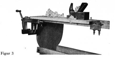
2. Schraubstock nach oben gerichtet zum Hobeln von Brettern in Hochkant-Stellung. In dieser Stellung dient der «Hobelfix» zugleich als Schraubstock und zwar für folgende Verwendungsvarianten:
