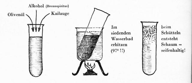
Durch die Beigabe von Alkohel wird die Versuchsdauer abgekürzt. Der erzeugte Seifenschaum wird von den Schülern zum Waschen der Hände benutzt; sie werden das Erlebnis nie vergessen.
