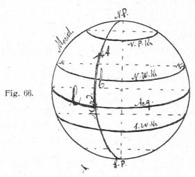
Um die Paralleloprojektion zu zeichnen, gehen wir von der Aufrisszeichnung aus, die zugleich einen Schnitt durch den Nullmeridian darstellt. Im Aufriss haben wir die grossen Achsen jener Ellipsen. So stellt z.B. KK die grosse Achse des Schattenbildes des nördlichen Wendekreises dar. Die kleine Achse ist der 4. Teil hievon und kann abgemessen werden.
