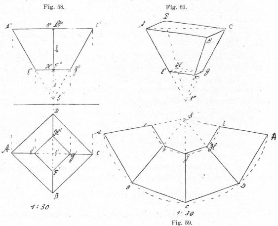
Wir denken uns den Körper so gestellt, dass 2 Seitenkanten und also auch je eine Diagonale von Grund- und Deckfläche parallel zur Aufrissebene laufen. Der Grundriss besteht aus zwei Quadraten, die bez. mit Grund- und Deckfläche kongruent sind. Die Grundrisse der Seitenkanten verbinden die entsprechenden Ecken dieser Quadrate. Der Aufriss des Pyramidenstumpfes ist ein Trapez; Grund- und Deckfläche erscheinen im Aufriss als Strecken, 2 Seitenlinien in wahrer Grösse.
