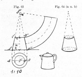
Beschreibung und Zeichnung grenzt von zwei ungleichen parallelen Kreisen als Grundund Deckfläche und von einem Mantel. A C heisst eine Seitenlinie des Stumpfs. Die Verbindungslinie der Kreismittelpunkte heisst seine Achse; sie gibt die Höhe an.
