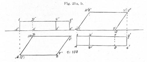
Fig. a geht in Fig. b über, wenn wir die Aufrissebene mit der Gundrissebene vertauschen.
