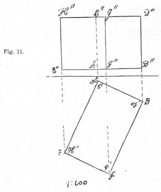
Verallgemeinerung. Wie haben wir in diesen Fällen den Grundriss und den Aufriss entstehen lassen? Was für einen Grundriss hatten Kanten und Flächen, welche parallel zur Grundrissebene lagen, solche, die zu ihr senkrecht waren? Was für einen Aufriss hatten solche Kanten und Flächen? Welche Kanten und welche Flächen haben sich in wahrer Grösse projiziert? (solche, die parallel zur Projektionsebene liefen). Welche erschienen in der Projektion verkürzt? (solche, die schief zur
