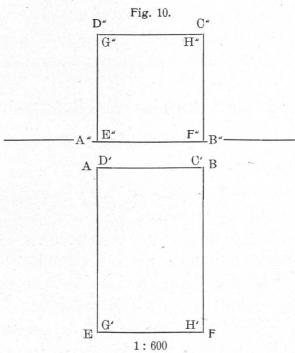
Wir wollen nun die Aufrissebene nicht abtrennen, sondern um die Linie, nach welcher sie die Grundrissebene schneidet. in die Grundrissebene umdrehen. Diese Schnittlinie nennen wir die Achse. Wie liegen Grund- und Aufriss eines Eckpunktes hinsichtlich der Achse? G" (Aufriss von G) liegt senkrecht über G' (Grundriss von G).
