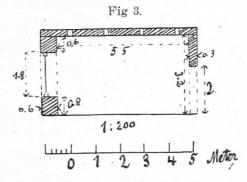
Berechne nun genau das ganze Mauerwerk (Rep. der Berechnung des Prismas mit trapezischer Grundfläche), sowie dessen Erstellungskosten.
