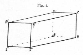
Bezeichnung. Die Punkte A, B, C, D sind Originalpunkte. E', F', G', H' sind Schattenpunkte oder Projektionen der vorderen Modellpunkte E, F, G, H. Das deuten wir durch Striche an.
